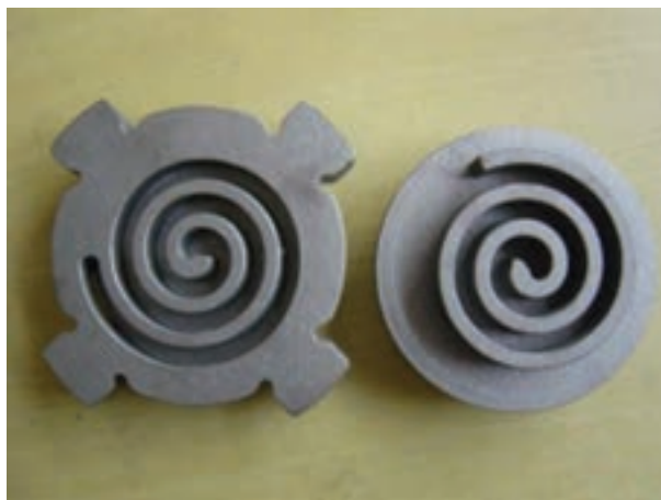
شکل ۳-۸- اسکرول ثابت و اسکرول متحرک
